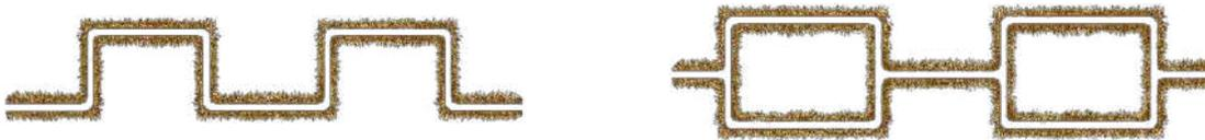
**Tranchées de tir en traverses, à gauche et en traverses tournantes, à droite**
