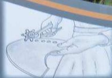
Afin de pouvoir appareiller les chaussures avec leurs accessoires : crochets, passe-lacets, agrafes, œilletons métalliques, l'**œilleuseuse** perce les trous appropriés dans les pièces de cuir.
