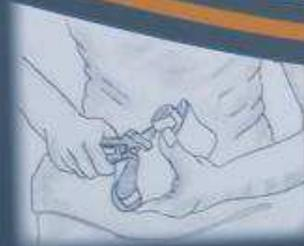
A l'aide d'une **pince à tendre**, le monteur tend le cuir, afin qu'il épouse la **forme** en bois, puis il fixe provisoirement l'ensemble à l'aide de quelques pointes.
